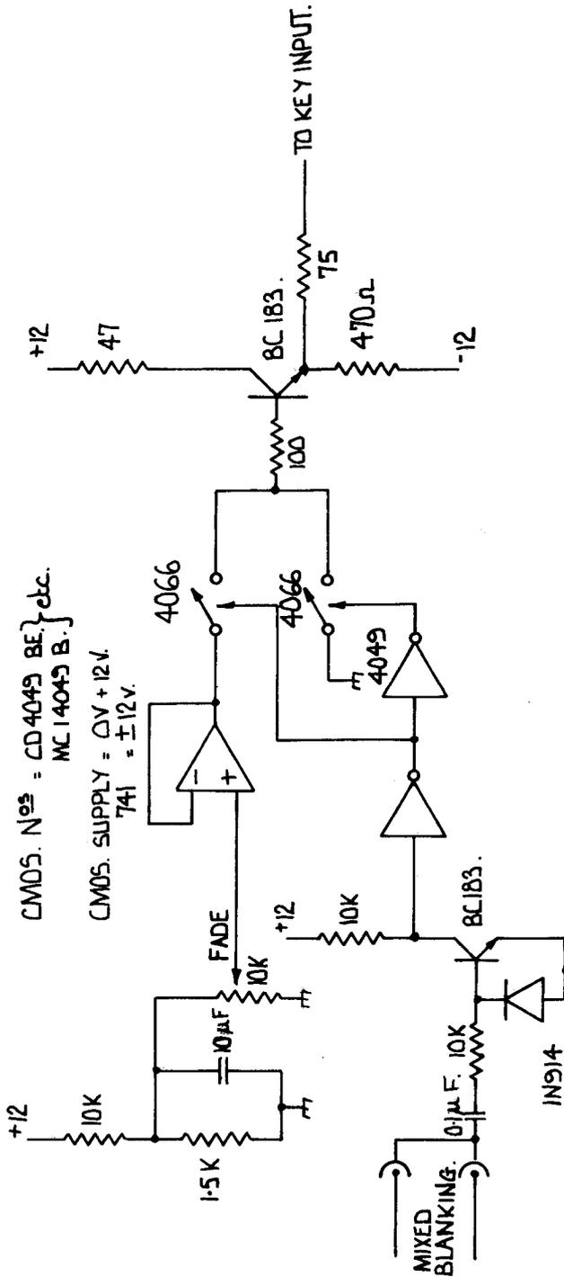
KEY SIGNAL GENERATOR FOR A/B CROSS FADE
