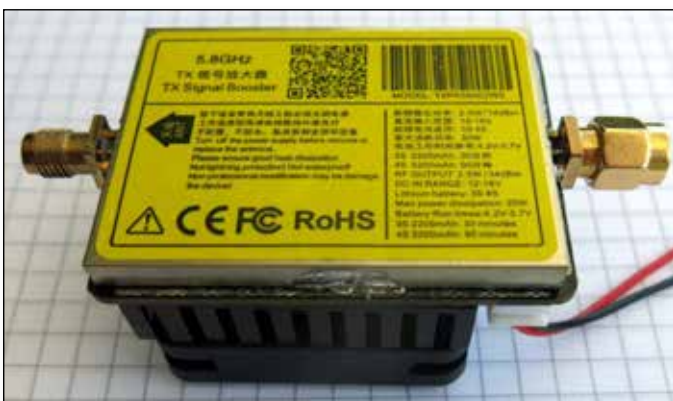
► Photo 1 TXPA58002W5 PA module for 5.8GHz
